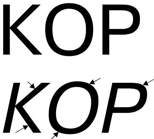
Рисунок 3.38 Искажение формы диагоналей и округлых элементов букв при механическом наклоне и их корректировка (ИТ Прагматика)
