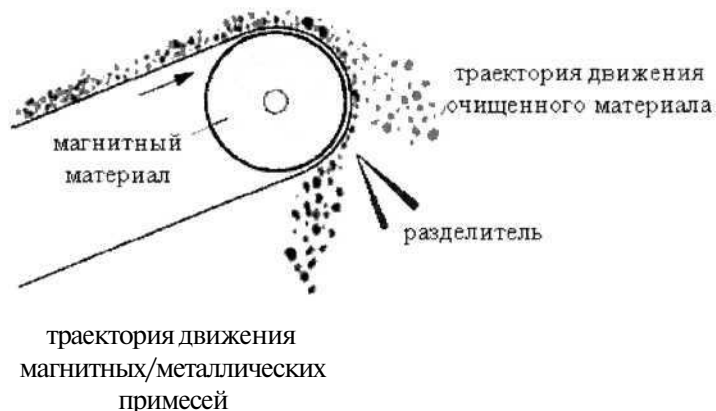
Рис. 6.3.3. Различные типы конфигурации барабанного магнитного сепаратора (Dings Co., Magnetic Group)
